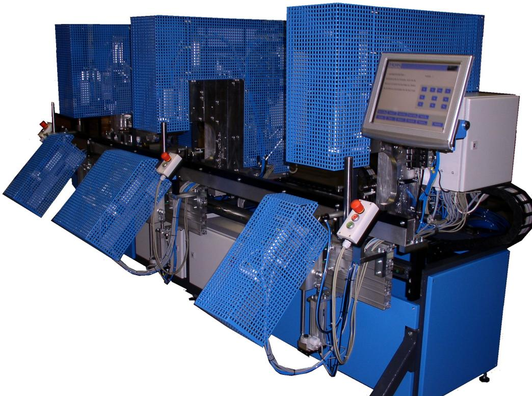
Ein Profilschenkel kann in einem Arbeitsgang an beiden Enden sowie gleichzeitig am Kämpfer bearbeitet werden.
