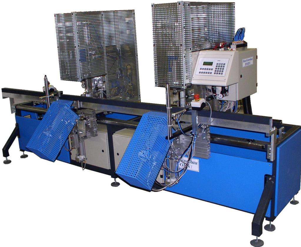
Ein Profilschenkels kann in einem Arbeitsgang an beiden Enden bearbeitet werden
