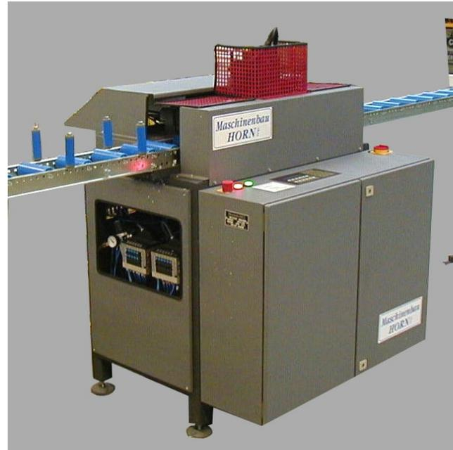
Profilbearbeitungszeit: ca. 2 Minuten (Standard- Profil: 1Meter – Blendrahmen ohne Kämpfer – insgesamt 16 Belüftungsschlitze)
