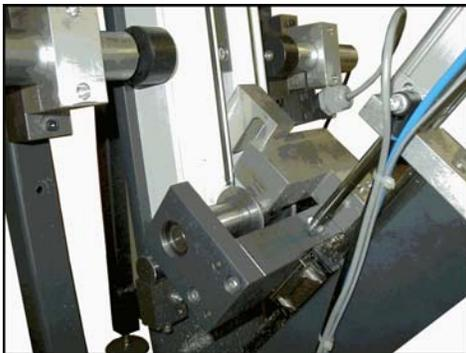
HDF-4: Pneumatische Spannung der Profile
